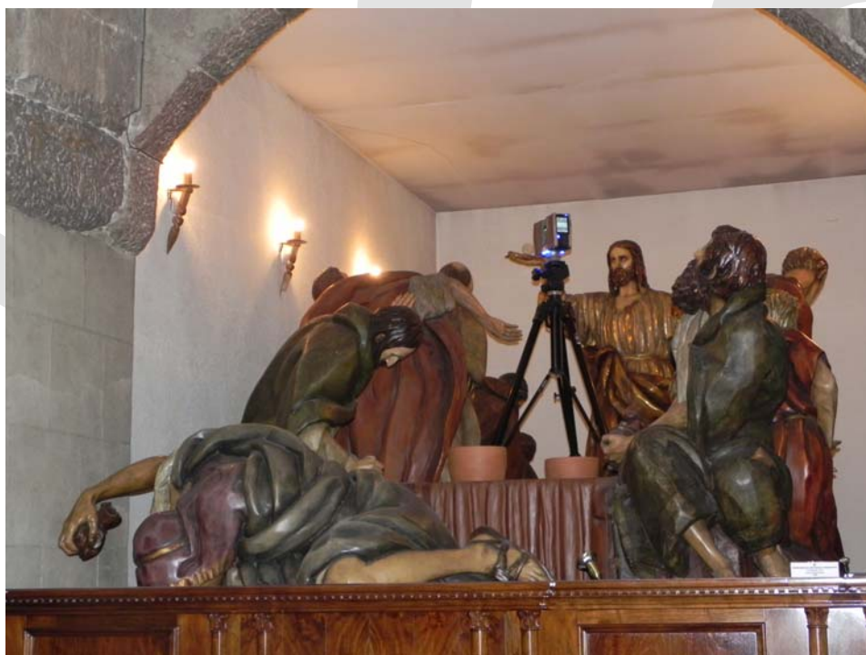
Detalle de las pruebas de digitalización con el equipo FARO Láser Scanner Focus 3D en el paso procesional de la Sagrada Cena, 2º de la PGSPR.
