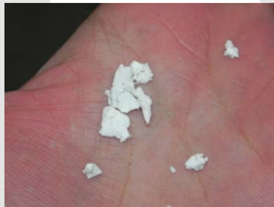
Detalle de la descarga de un extintor de CO 2 y el residuo de hielo seco que genera durante unos instantes. Acto seguido no queda ningún residuo.
